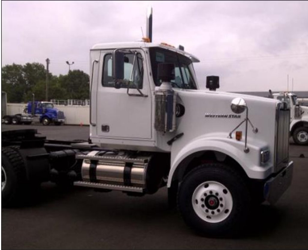
Figura 4. Tracto Camión Western Star 4900FA, modelo 2015, de eje delantero avanzado, capacidad de movimiento de 250,000 libras
