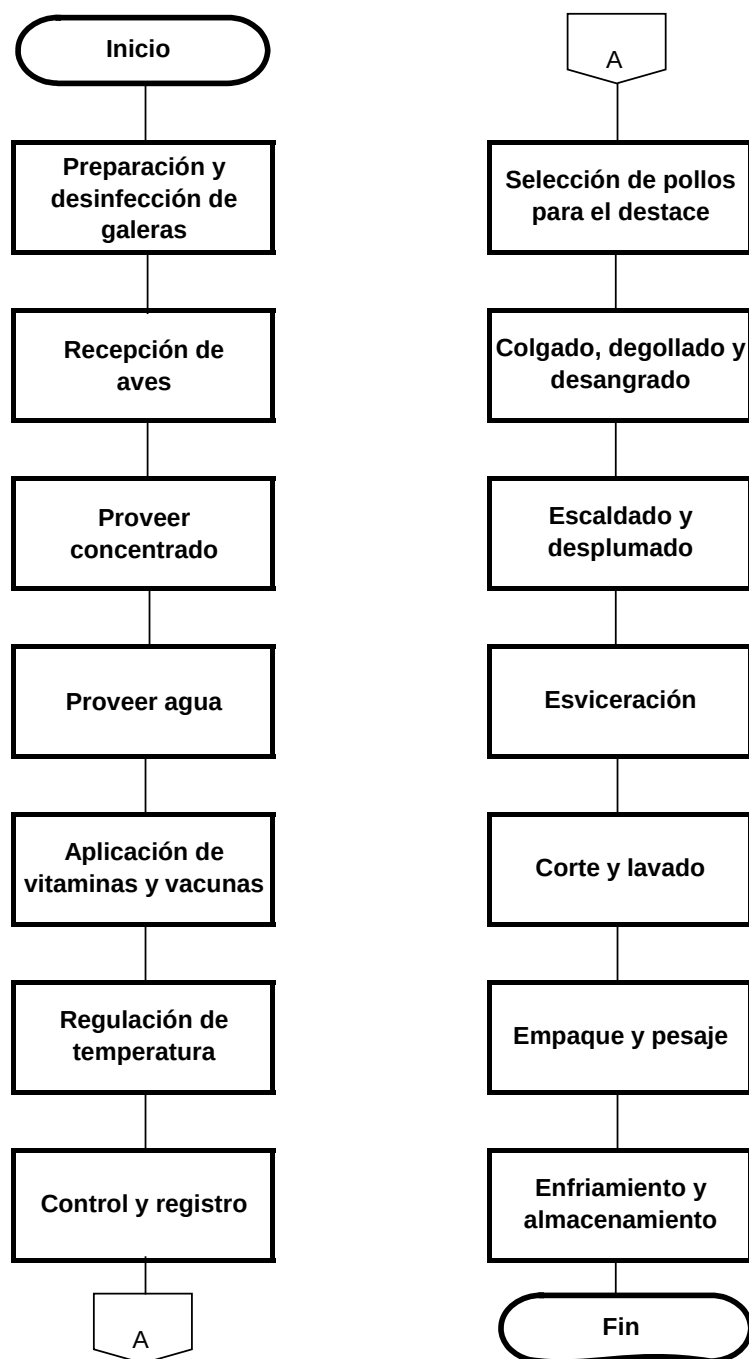
Gráfica 4 Municipio de Concepción Huista - Huehuetenango Proyecto: engorde y destace de pollos Flujograma del proceso de producción de engorde y destace de pollos Año 2004
