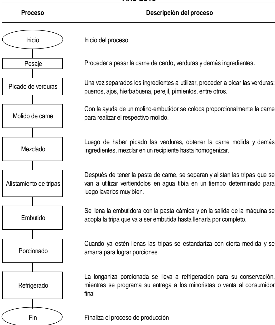
Gráfica 5 Municipio de El Chal, Departamento de Petén Proyecto: Producción de Embutidos Flujograma del Proceso Productivo Año 2015
