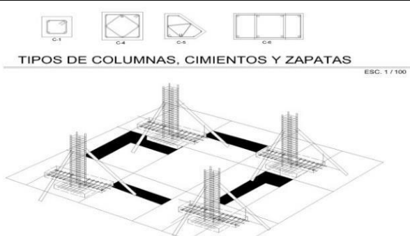
Levantado de zapatas y columnas principales
