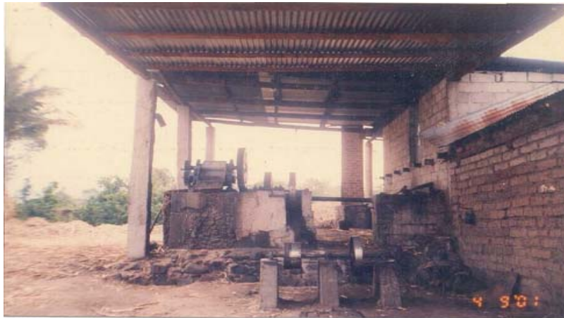
Motor especial, utilizado en un trapiche, para moler la caña de azúcar.
