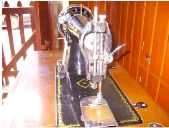
PALANCA ALZADORA DE LA BARRA DEL PRENSATELAS.
