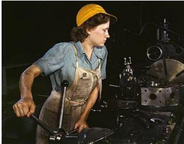
Ilustración 2 En 1942, durante la Segunda Guerra Mundial, una trabajadora labra piezas en un torno revolver para aviones en la fábrica de Consolidated Aircraft Corporation en Fort Worth, Texas, Estados Unidos.
