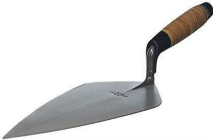
Esta herramienta sirve para la preparación de mezclas, así como para realizar el repello de la estufa.
