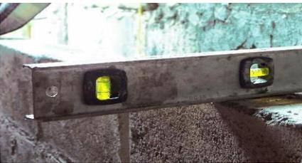
Herramienta que permite dar el nivel adecuado para la estabilidad de la estufa.
