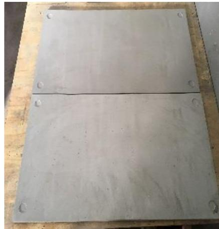
Las planchas de cemento permiten la firmeza de la estufa y a la vez sostienen las piezas de la cámara de combustión.
