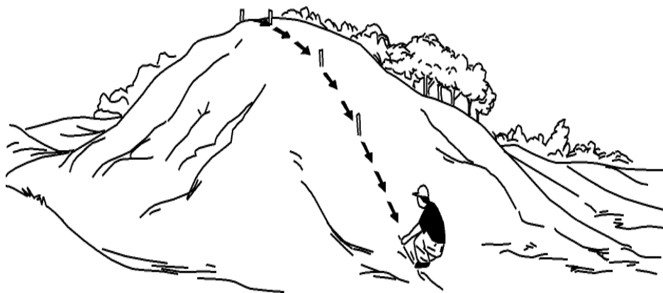
Figura del trazo de línea central en el trazo de curvas a nivel.
