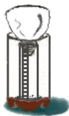
7. Para armar el pluviómetro, pon la parte de arriba de la botella - como si fuera un embudo- adentro del recipiente cilíndrico (vacío), e introduce éste en la parte inferior de la botella.
