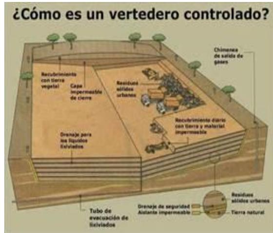
La descomposición anaeróbica de los residuos orgánicos genera gases. Si se concentra una cantidad considerable de metano se pueden producir explosiones, por lo que el vertedero debe tener buena ventilación. Técnicas más recientes apuestan por el aprovechamiento de estos gases procedentes de la descomposición como recurso energético.
