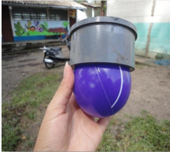
(Imagen tomada por la Epesista, esta pelota se le colocó dentro del tubo que describiré a continuación, para que al momento de que la basura pase por el canal y el tubo, este al llenarse, tope en un reducidor de diámetro de la tubería y esto al terminar de llover se abre la llave del decantador y este queda listo para la próxima caída de lluvia, evitando así que en la tubería parase agua sucia)
