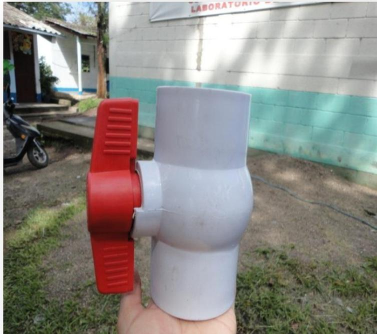
(Imagen tomada por la Epesista, con ayuda del Ingeniero Jorge Donis, nos inventamos un decantador, que servirá para mantener limpia el agua y este se pueda utilizar con mayor seguridad, este objeto señalado en la fotografía, sirve para que cuando se llene de basura el tubo, se destape y este quede limpio para continuar captando agua de lluvia)
