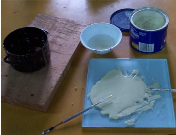
Materiales utilizados en la elaboración del resane. carbonato de calcio, cola de res y agua
