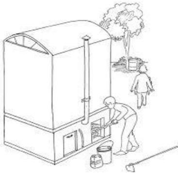
Construido con tanque cilíndrico de acero inoxidable que contiene una solución de soda cáustica (NaOH) destinada a recibir las excretas. Este tanque es removible. La dosis recomendable es de 10 kilos de NaOH para 50 litros de agua. Debido a su costo elevado es aplicado en circunstancias especiales.
