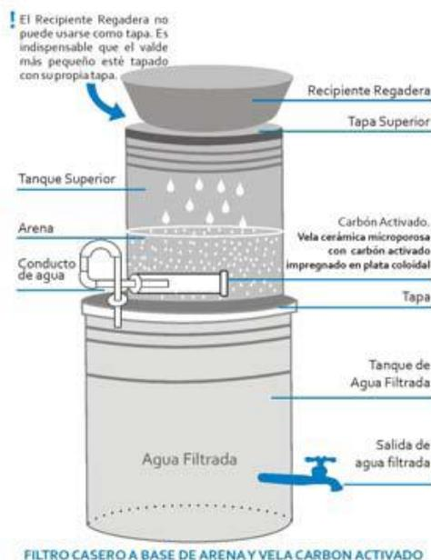
Otros métodos sencillos para desinfectar el agua filtrada se hace, mediante el uso de carbón activado luego de la arena, esto con el fin de mejorar el color, olor y sabor del agua, así como la retención de algunas sustancias orgánicas. Adicionalmente se puede utilizar plata coloidal que realiza una acción de eliminación de bacterias y virus.
