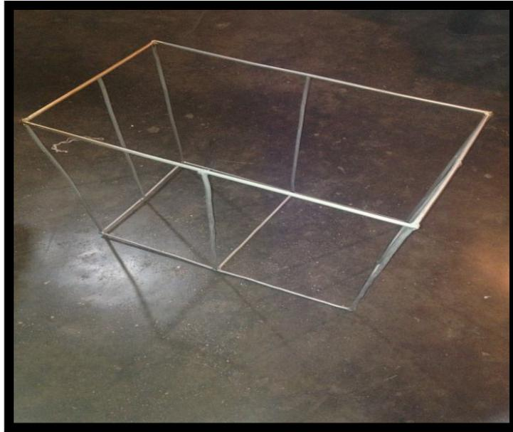
Elaboración de bases de metal para los depósitos para basura con hierro y soldadura, este procedimiento se realizo en un taller.
