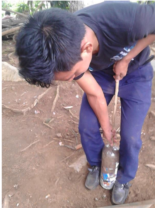
Estudiante formando ecoladrillos (botellas plásticas llenas de bolsas plásticas) para hacer sillones en el patio del establecimiento educativo.
