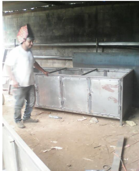
Foto No. 7/Construyendo mesas de laboratorio/Angélica Silva- Paola Navarajo/EPS. –Cunsaro_
