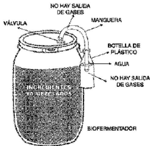
Biofermentador: sistema hermético para la preparación de biofermentos. (Tomado de: Restrepo, 2002)
