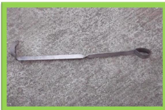
j) **Regulador de la chimenea:** “Es la estructura metálica con la finalidad de que el calor no se escape y tenga más rendimiento al momento de cocinar”<sup>26</sup>.
