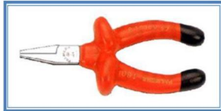
**Pinza de Boca Redonda:** Su boca acaba en dos piezas redondas. Son muy útiles para dar formas a los conductores rígidos, hoy día todos los conductores de poca sección se utilizan en forma de cable flexible, por lo que cada día se usa menos esta herramienta.
