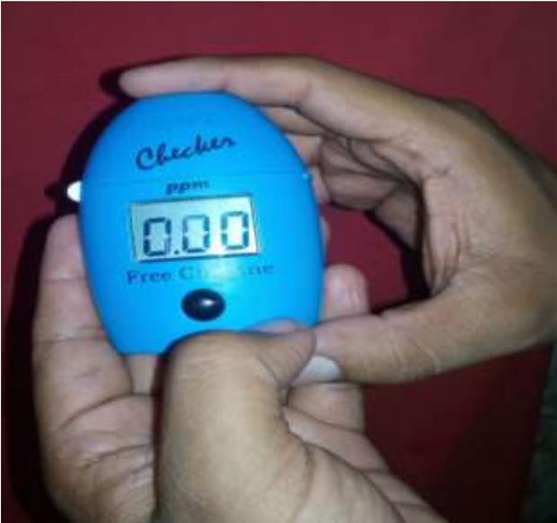
En este caso las pruebas indican que no existe purificación de agua, en el tanque de captación de agua ni en las viviendas a las que llega.
