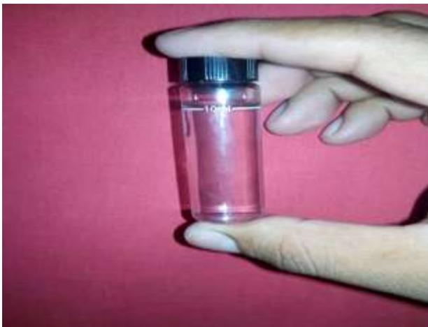
Posee dos recipientes de vidrio con la medida de diez milímetros, se introducen al comparímetro con la medida exacta de agua.
