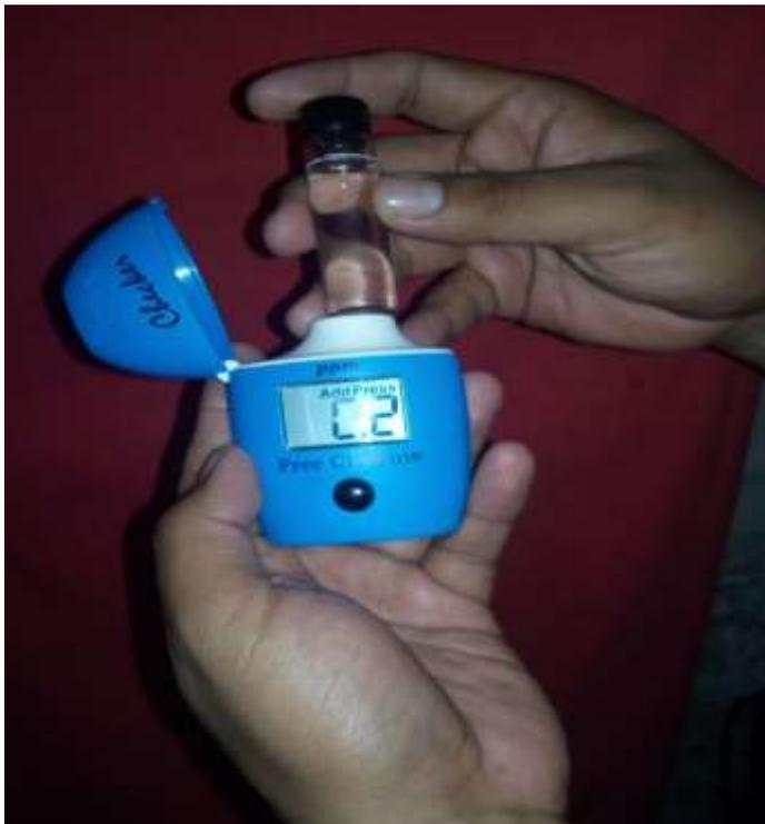
Se introduce el recipiente con la medida exacta de agua, la pantalla marca que es la segunda prueba, durante los siguientes 15 segundos se determinará el resultado de hipoclorito de sodio.
