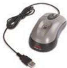
**Mouse:** Es un dispositivo apuntador, generalmente fabricado en plástico. Se utiliza con una de las manos del usuario y detecta su movimiento relativo en dos dimensiones por la superficie plana en la que se apoya, reflejándose habitualmente a través de un puntero o flecha en el monitor.
