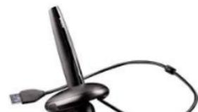
**Lápiz óptico:** Es un periférico de entrada para computadoras, tomando en la forma de una varita fotosensible, que puede ser usado para apuntar a objetos mostrados en un monitor.
