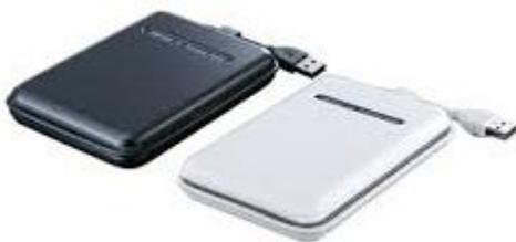
**Disco duro extraíble:** Es un disco duro que es fácilmente transportable de un lado a otro sin necesidad de consumir energía eléctrica o batería.
