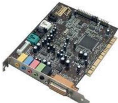
**Tarjeta de sonido:** es una tarjeta de expansión para computadoras que permite la entrada y salida de audio bajo el control de un programa informático llamado controlador.
