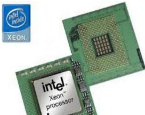
Es el circuito integrado central y más complejo de un sistema informático; a modo de ilustración, se le suele asociar por analogía como el «cerebro» de un sistema informático. El procesador puede definirse, como un circuito integrado constituido por millones de componentes electrónicos agrupados en un paquete. Constituye la unidad central de procesamiento (CPU) de un PC catalogado como microcomputador.
