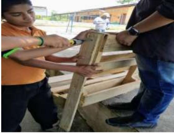
6. Atornillar las barras de madera de 24 pulgadas en cada esquina de la banca para que sirvan como patas.
