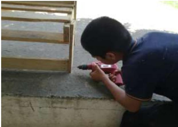
7. Colocar dos barras de madera como refuerzo para las patas. Atornillarlas en un ángulo de 45 grados
