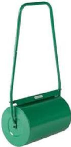
El rodillo metálico, o rulo, es otro elemento importante en el jardín. Se rellena de agua o arena en una cantidad que depende del peso que se necesite, según las características del terreno. Su utilidad es la de aplanar la tierra y compactarlo, adaptando el césped al terreno. Otro uso que se le da es el de alisar caminos de arena, grava o tierra apisonada.
