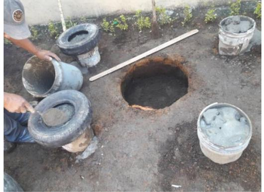
Foto7. Fundición con neumáticos de Mototaxis rin número 8.
