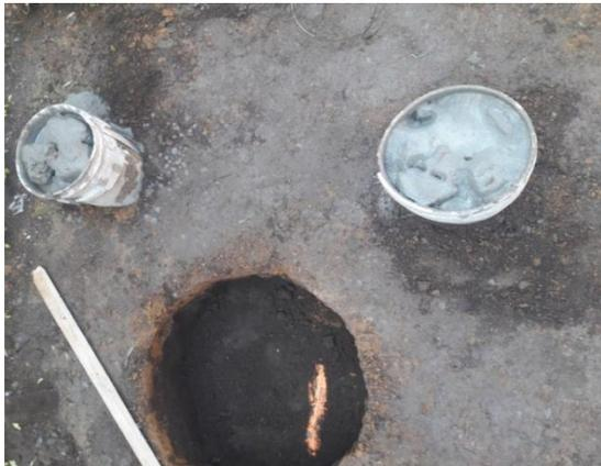
Foto6. Fundición con cubetas de pintura.
