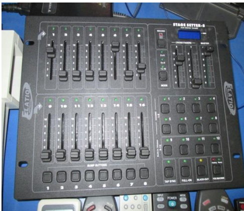
Switcher digital para manipular la iluminación desde cabina de grabación 6/10/2014
