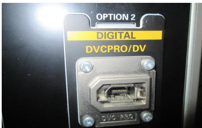
Tarjeta digital instalada en el VTR grabador convertido en digital activado
