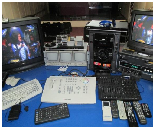
Switcher digital para manipular la iluminación desde cabina de grabación 6/10/2014
