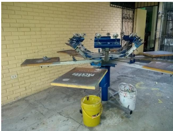
Referencia: Máquina para impresión de serigrafía textil, garaje de Estigma Industria Serigráfica.
