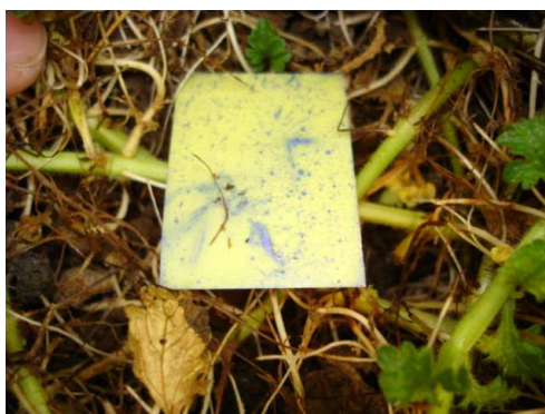
Figura 49. Papel hidro sensible luego de aplicación con “aguilón”
