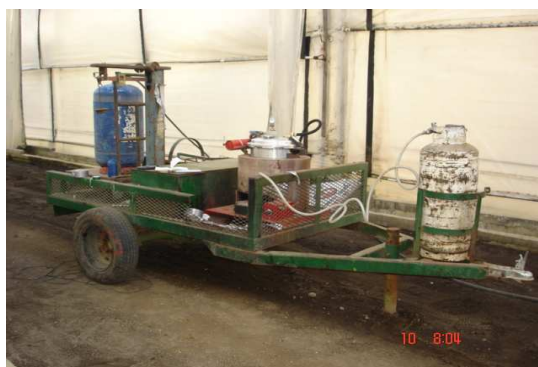
Figura 7. Caldera para aplicación del Bromuro de Metilo
