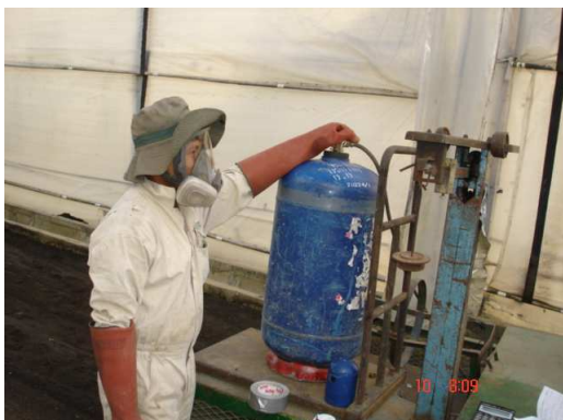
Figura 8. Operario abriendo llave de paso para inyección de Bromuro de Metilo
