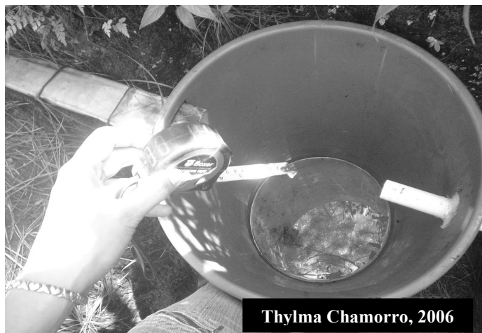
Figura 2.6 Medición de alturas en los botes recolectores con cinta métrica.
