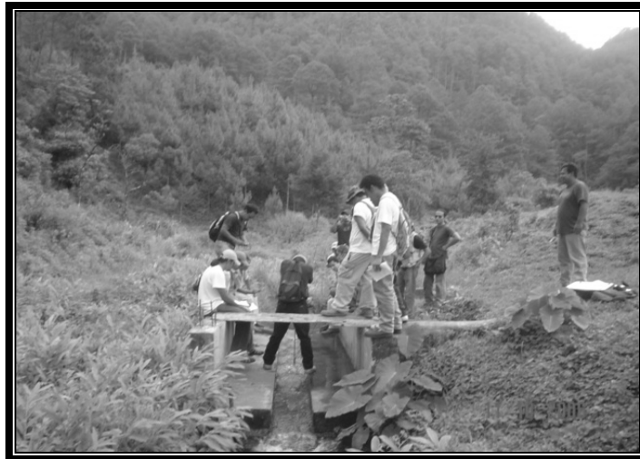
Figura 3.3 Medición de la profundidad del caudal que pasa por el canal de aforo ubicado en el cauce principal de la microcuenca.
