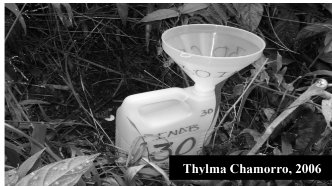
Figura 2.11 Pluviómetros móviles con embudo de diámetro de 16 cm.
