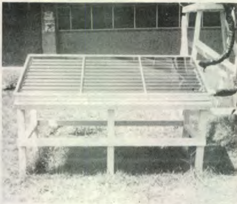
FIGURA 20 Vista del Colector Solar Plano inclinado acorde a la Latitud Geográfica de Guatemala. Se aprecia el Absorvedor y la tubería del flujo de agua.
