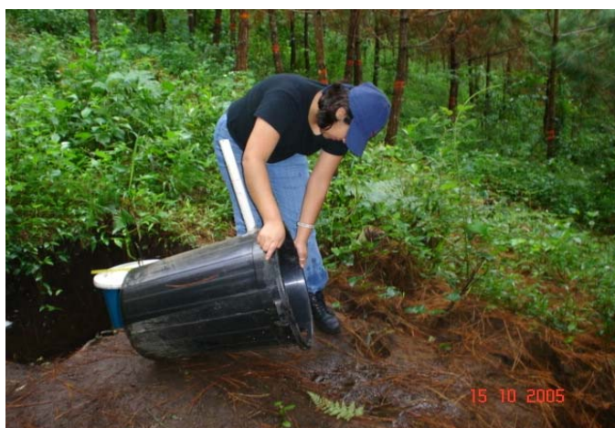
Figura 59. Decantación del agua para obtener muestra de sedimentos
