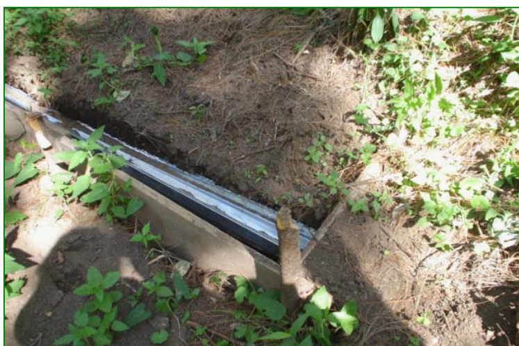
Figura 9. Canal de captación de agua y sedimentos, de las parcelas de escorrentía.
