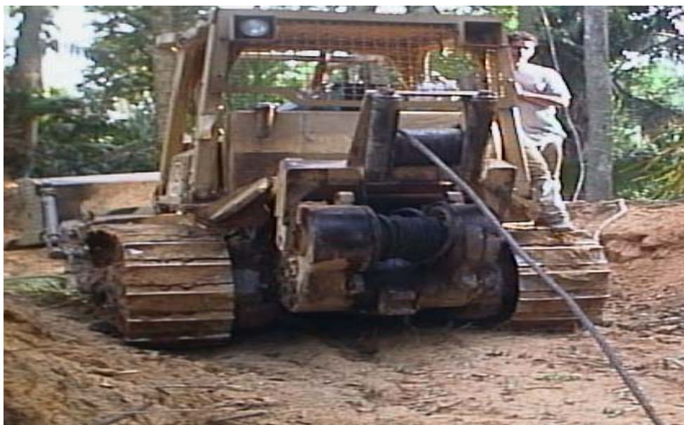
Figura 32: Malacate modelo 55 en tractor D5B
