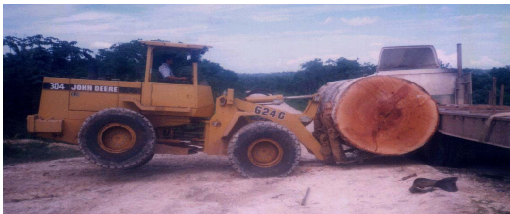
Figura 8: Carga de madera utilizando cargador frontal.
