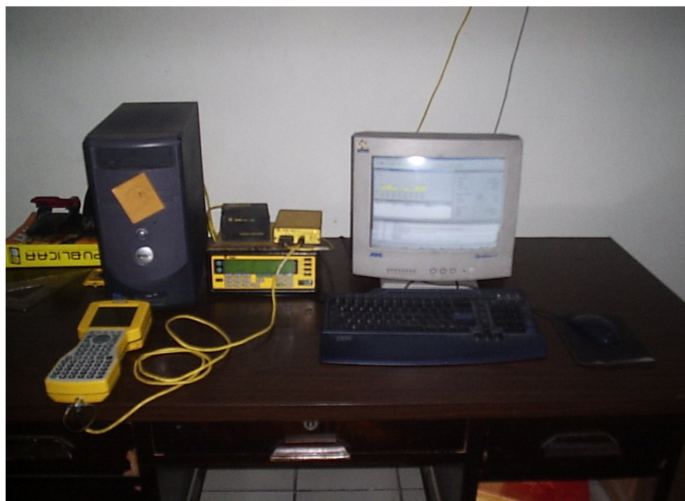
Figura 30A. Sistema de Posicionamiento Global Diferencial (Estación Base).
