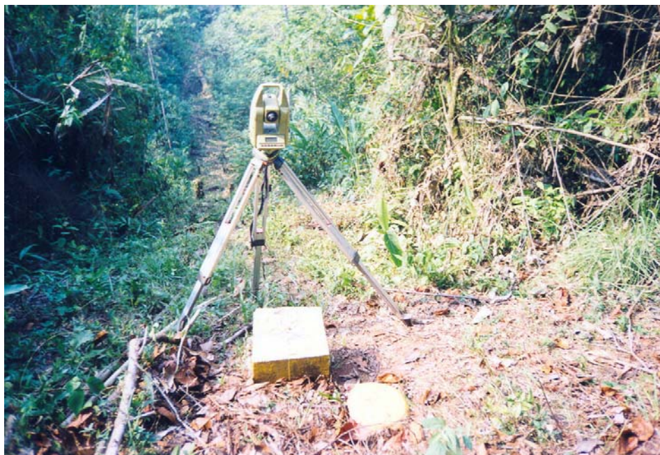
Figura 32A. Estación Total TC600 utilizada para la medición de los diferentes lotes.
