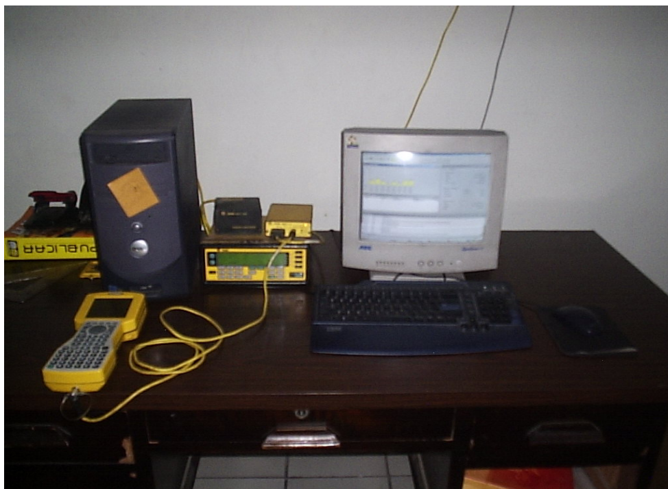
Figura 34A. Sistema de Posicionamiento Global Diferencial (Estación Base), utilizado para la corrección del Levantamiento Satelital.
