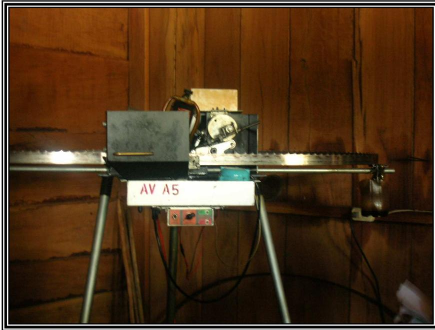
**Figura 4 A. Sierra de banda y afilador, del aserradero Árbol Verde**
