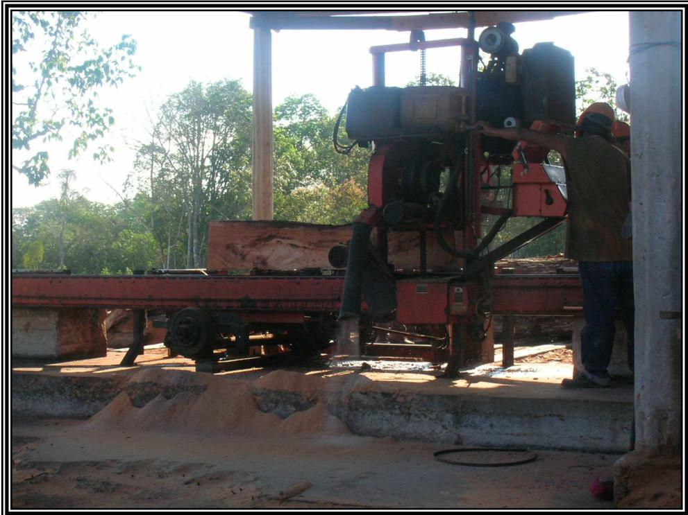
**Figura 3 A. Aserradero Portátil Wood-Maizer del Aserradero Árbol Verde**
