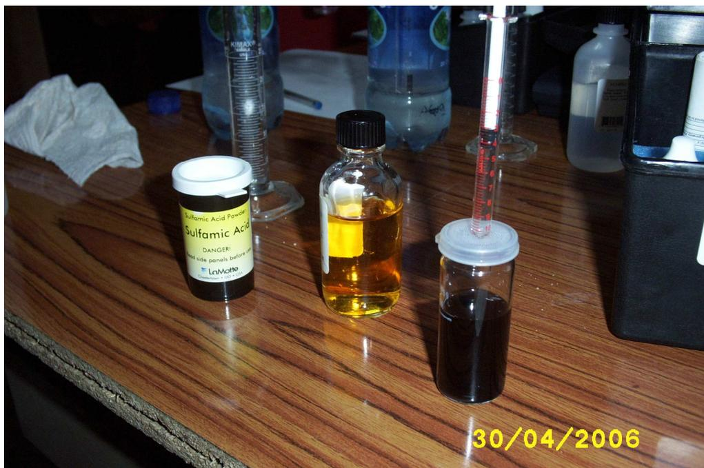
Fotografía 1. Pruebas de titulación con el kit de campo Smart Water Analysis Laboratory LaMotte.
