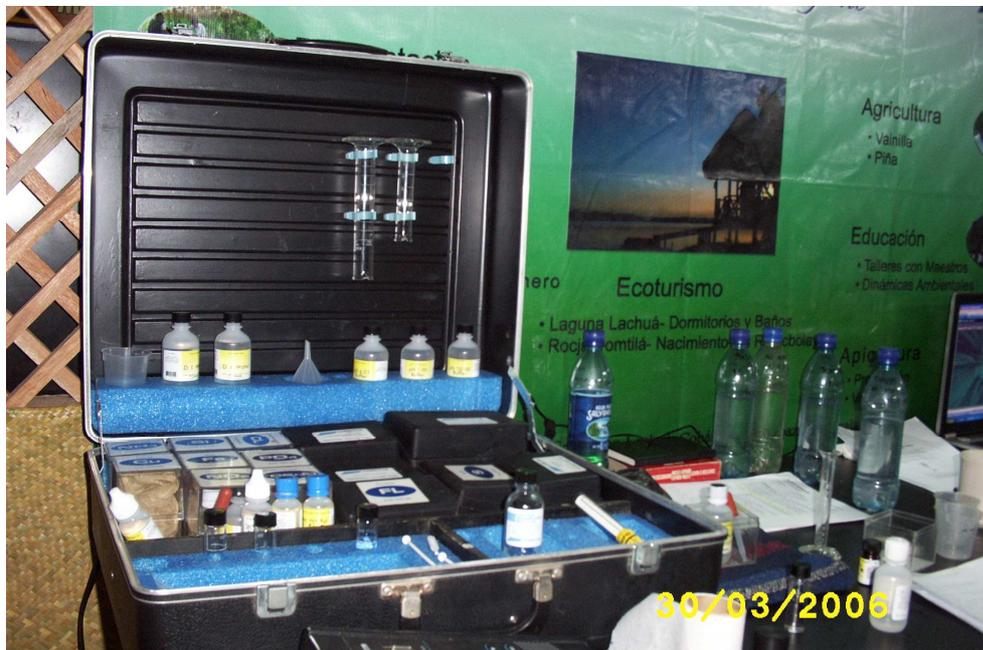
Figura 8. Kit Smart Water Analysis Laboratory LaMotte con diferentes reactivos. 2006
