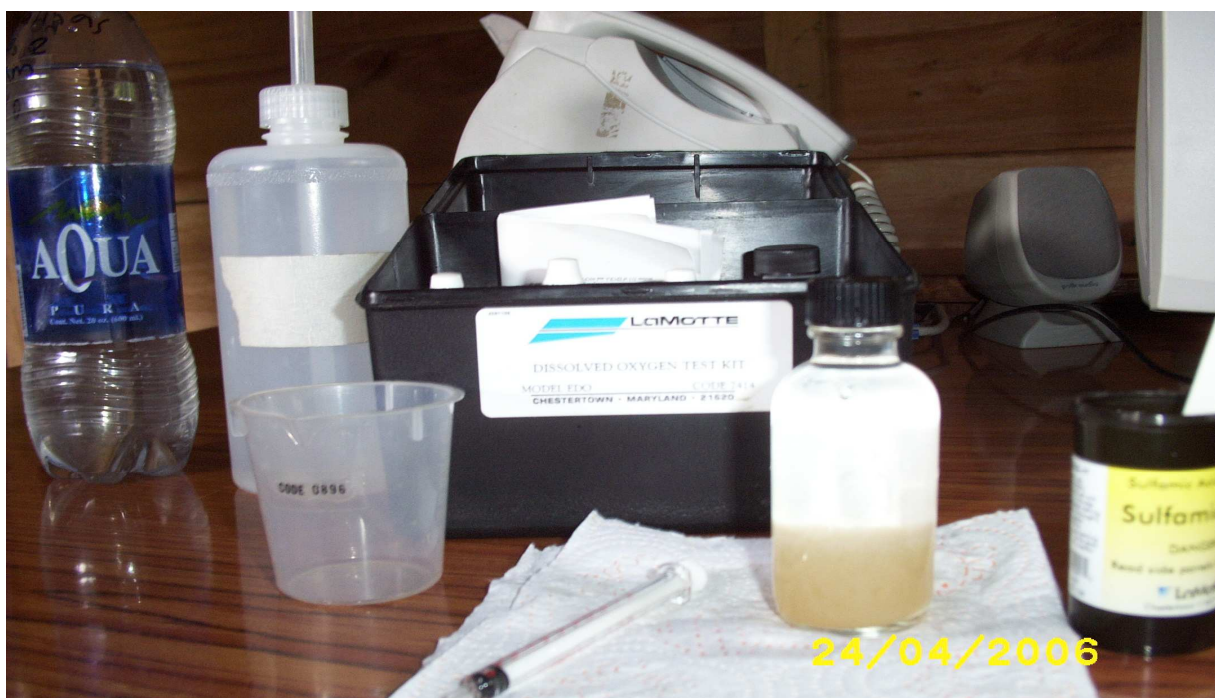
Figura 54 Prueba de titulación del kit "smart water analysis".
