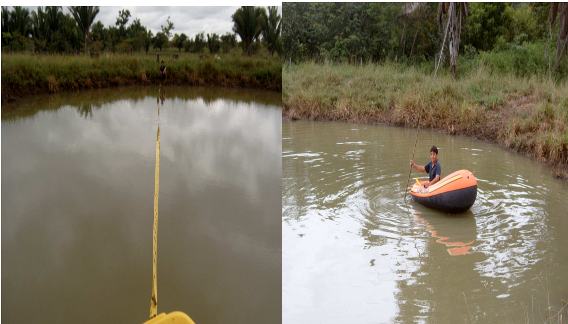
Figura 16 A. Proceso de estimación de capacidad de almacenamiento de las aguadas en el campo.
