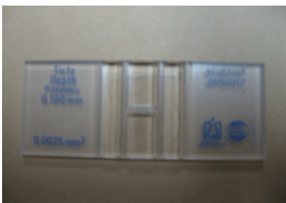
Figura 42 C3mara de Neubauer o Hemacit3mero de Neubauer, utilizado para el conteo de conidias.
