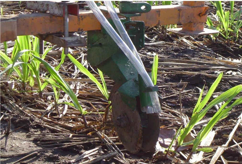
**Figura 4.** Discos rompe-cepas adaptados a una barra fija acoplada a los tres puntos del tractor utilizados en la aplicación de insecticidas granulados al suelo.
