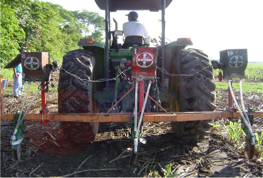
**Figura 3.** Maquinaria, Implementos y forma de aplicación de insecticidas granulados para el control del complejo de larvas de la raíz de la caña de azúcar.
