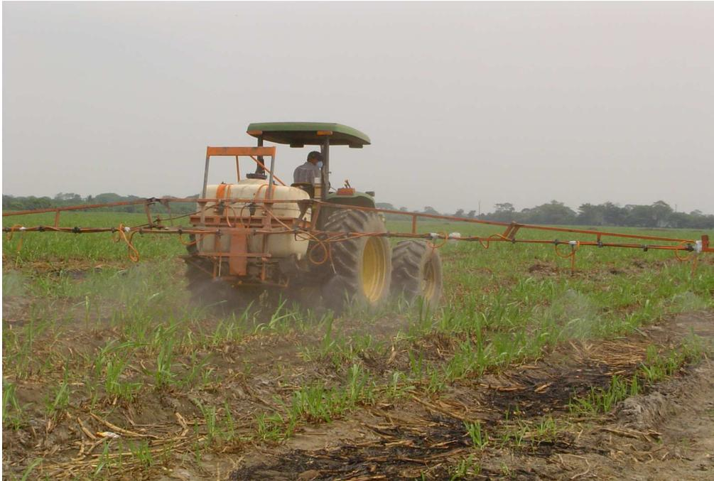
**Figura 5.** Maquinaria, Implementos y forma de aplicación de insecticidas con formulación líquida para el control del complejo de larvas de la raíz.
