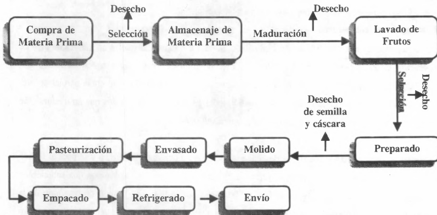
Figura 3. Flujo del Proceso para la Obtención de Pulpa Congelada de Zapote
