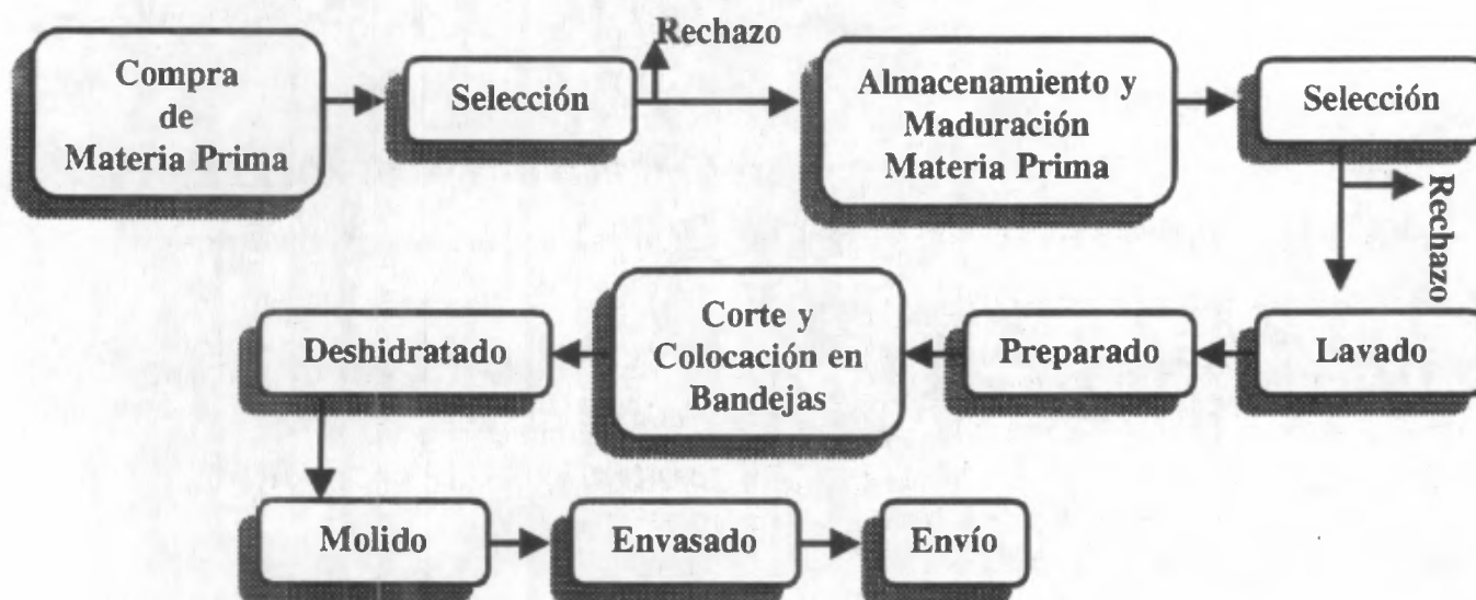
Figura 8. Flujo del Proceso para la Producción de Harina de Zapote
