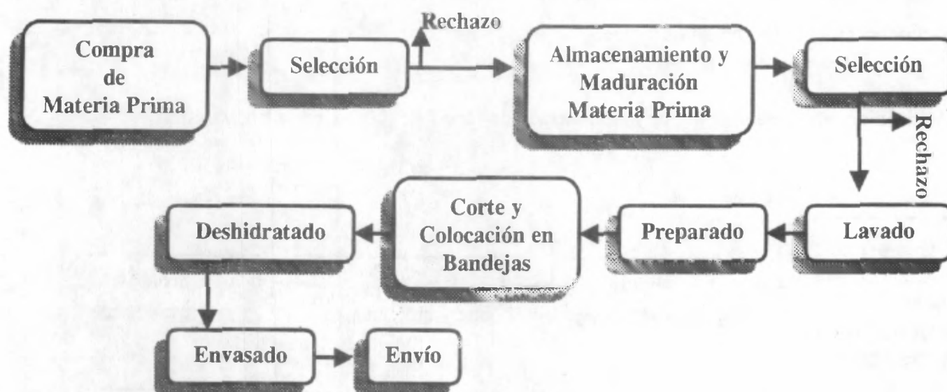
Figura 9. Flujo del Proceso para la Producción de Pulpa Deshidratada de Zapote
