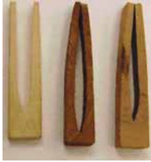
Figura 7 Pruebas de tensión. La muestra de la izquierda no presenta evidencia de estrés, mientras que las dos de la derecha presentan endurecimiento superficial. Fuente: Wengert 1992.
