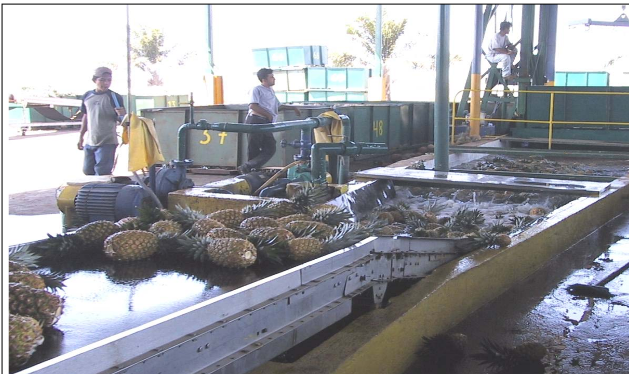
Figura 20A: Acopio del fruto: tratamiento con agua clorada, finca La Plata, Coatepeque, Quetzaltenango
