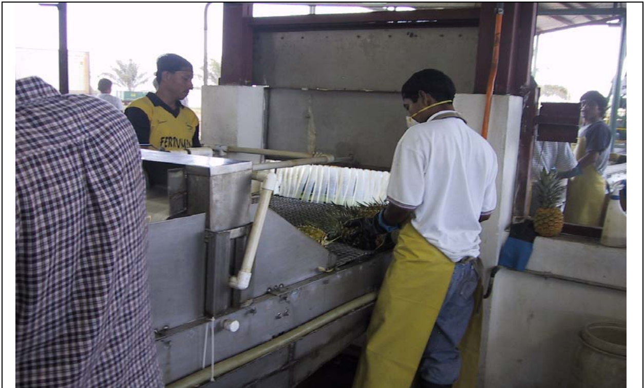
Figura 24A: Secado por aplicación de aire a la fruta, área de empaque, finca La Plata, Coatepeque, Quetzaltenango.
