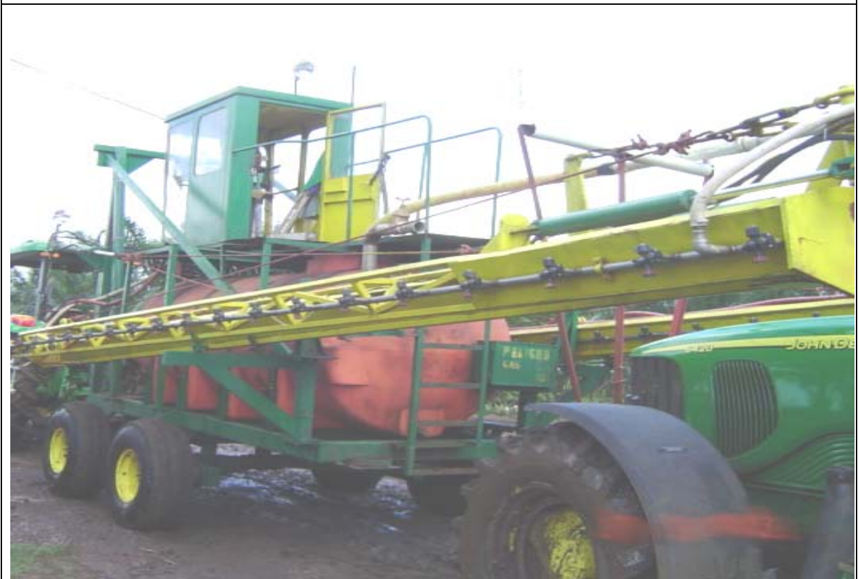
Figura 13A: Spray-Boom, maquinaria de aplicaciones para: fertilización foliar, plaguicidas, inducción de floración y madurantes, finca La Plata, Coatepéque, Quetzaltenango
