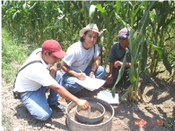
Fotografía No. 10: Pruebas de infiltración realizada en una de las cinco parcelas seleccionadas, por medio del infiltrometro de doble cilindro. A la izquierda canalero encargado del sector 1, al centro EPS y al lado derecho canalero encargado sector 2.
