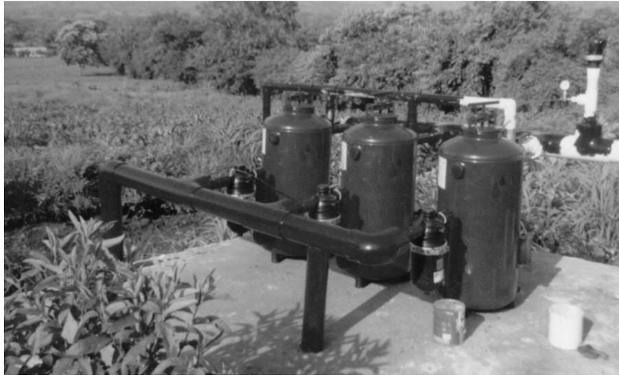
**Figura 2. Vista de una batería de filtros de grava y de mallas**
