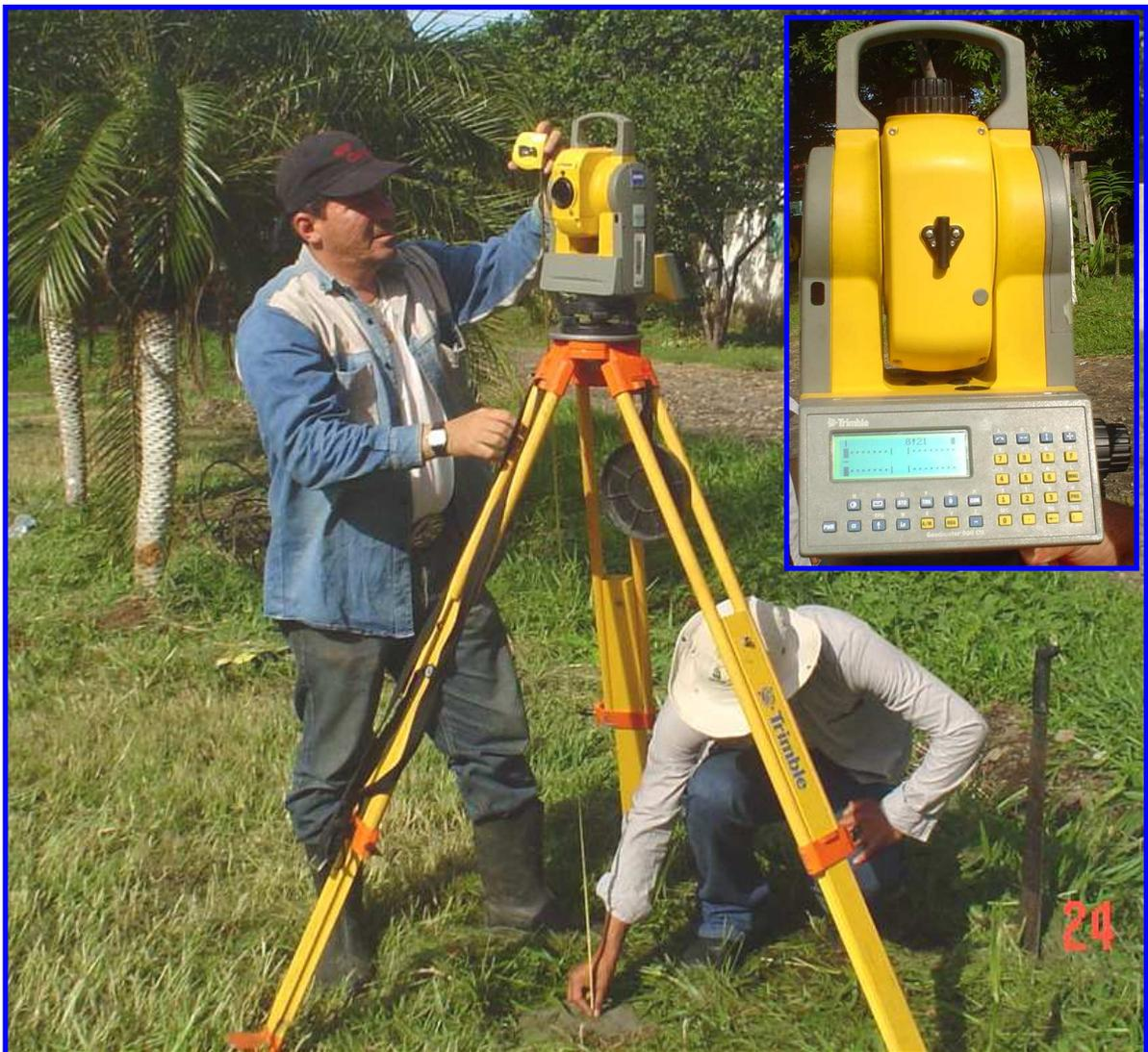
Figura 2. Centrado, nivelado y toma de cota con la estación total Trimble 3603 DR
