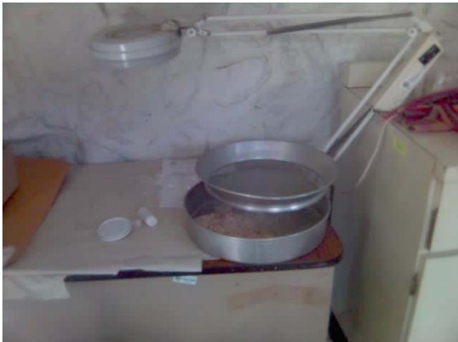
**Figura 9 A.** Equipo de Pre-diagnostico de plagas, utilizado en oficinas de SEPA, para la observación de los diferentes insectos colectados en la inspección de los contenedores y también de los resultados eficacia para el control de insectos obtenidos de las evaluaciones de los tratamientos aplicados a los contenedores con granos. Fecha 27 de Septiembre de 2,005. Puerto Santo Tomás de Castilla, Izabal.
