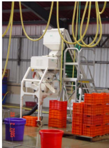
Figura 3. Maquina extractora de semilla.
