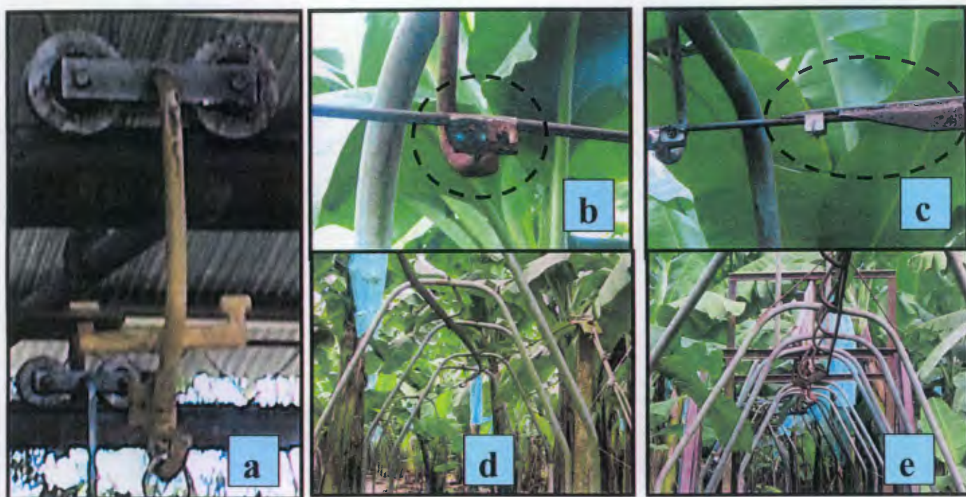
Figura 12. a) Carrito que actualmente se emplea para transportar los racimos de banano por el cable-vía sin sistema de amortiguamiento y que corresponde al tratamiento testigo, b) clips, c) switches d y e) curvas del cable vía.
