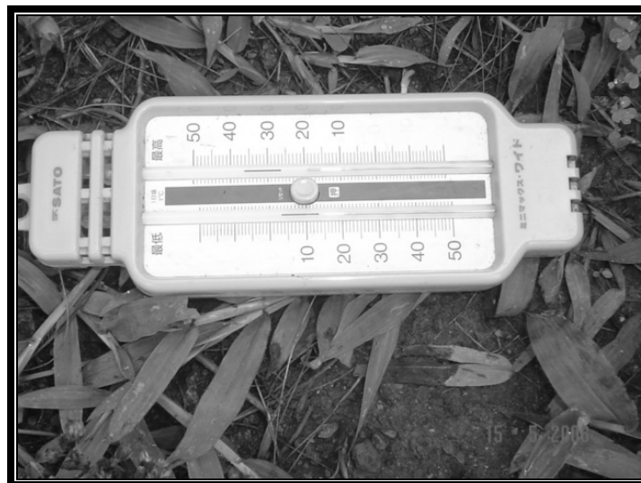
Figura 3.2 Termómetro de máximas y mínimas utilizado para la medición de temperatura.
