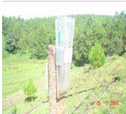
Figura 3.1 Medición de la precipitación pluvial en al estación ubicada en la parte baja de la microcuenca.
